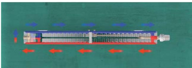
Der therm-x2 arbeitet mit dem innovativen Prinzip der seriellen Durchströmung. Das heißt: Während bei der bisherigen Flachheizkörper-Technik alle Platten gleichzeitig erwärmt werden, wird hier die Frontplatte zuerst durchströmt. Das Ergebnis: Bis zu 11 % Energieersparnis gegenüber herkömmlicher Flachheizkörper-technik. Bis zu 25 % kürzere Aufheizzeit des Heizkörpers. Und bis zu 100 % mehr behagliche Strahlungswärme.
