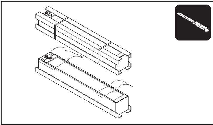
**4 Legen Sie den verpackten Heizkörper mit der oberen Abdeckung nach unten auf den Boden.**
