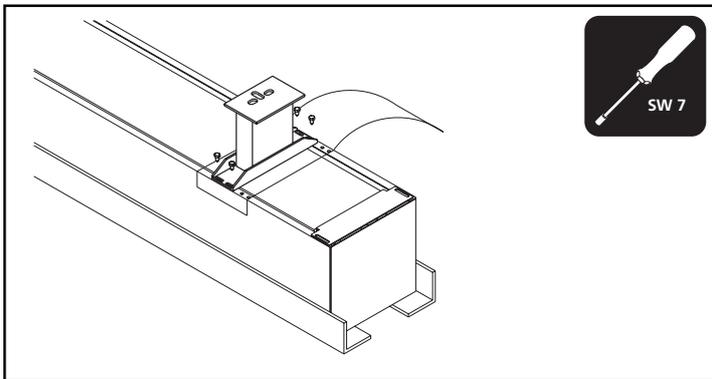
**5 Befestigen Sie die Konsolen mit den Blechschrauben am Heizkörpergehäuse.**
