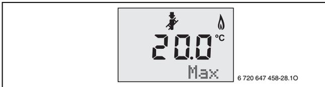
Bild 56 Max (= maximale Nennwärmeleistung) blinkt
