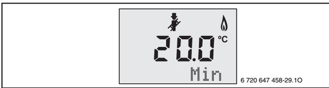
Bild 52 Min (= minimale Nennwärmeleistung) blinkt
