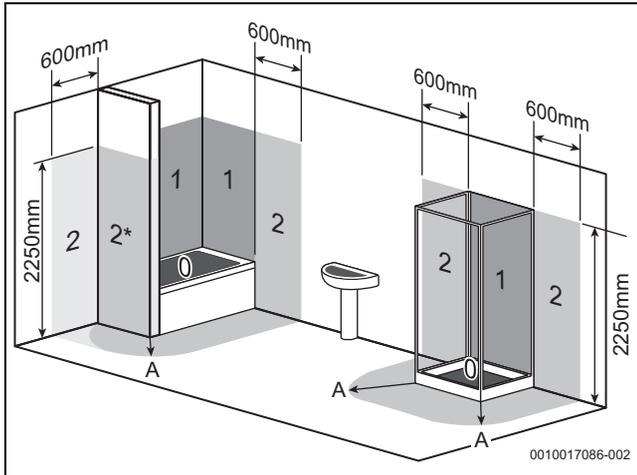
Bild 49 Schutzbereiche (Beispieldarstellung)
