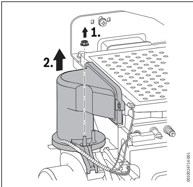
Bild 71 Mischeinrichtung ausbauen
