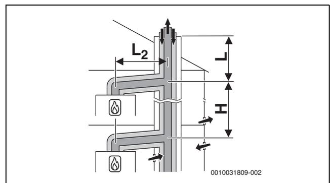
Bild 42 Mehrfachbelegung nach C<sub>(11)3x</sub> mit kollektiv konzentrischer Luft-Abgas-Führung im Schacht und konzentrischer Luft-Abgas-Führung im Aufstellraum
