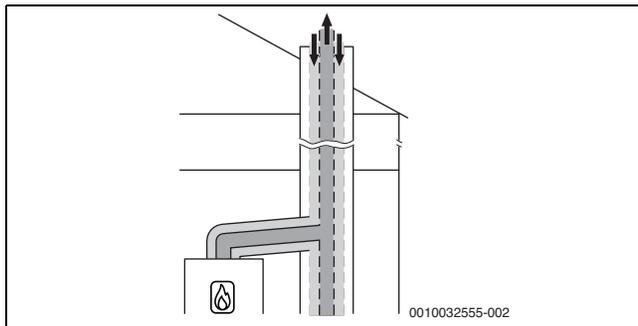
Bild 31 Konzentrische Luft-Abgas-Führung nach C<sub>43x</sub> im Aufstellraum
