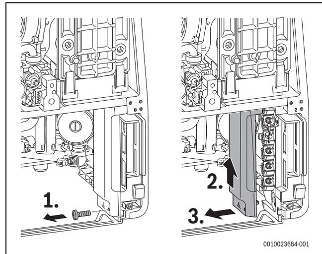
Bild 50 Abdeckung lösen
