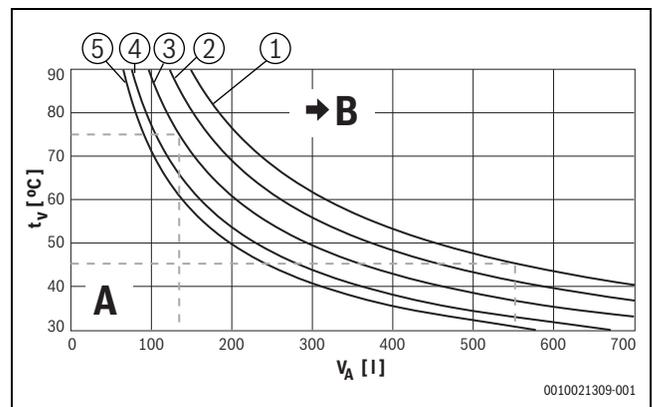
Bild 17 Kennlinien des Ausdehnungsgefäßes, Heizungsausdehnungsgefäß 14 l
