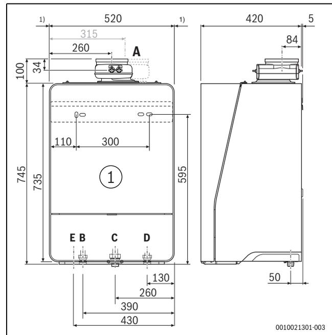
Bild 5 Typ H - Abmessungen und Anschlüsse [mm]
