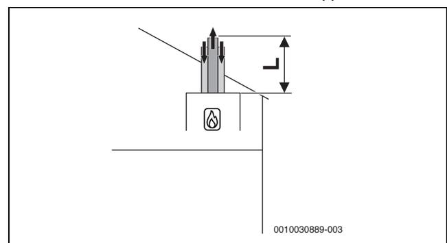
Bild 30 Vertikale konzentrische Luft-Abgas-Führung nach C<sub>33x</sub>
