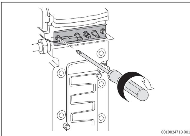
Bild 67 Elektroden-Set montieren
