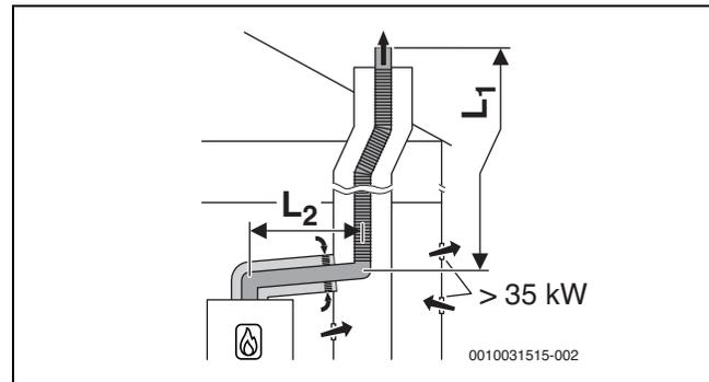
Bild 40 Flexible Abgasführung im Schacht nach B<sub>33</sub> mit raumluftabhängiger Luftzufuhr über die konzentrische Luft-Abgas-Führung im Aufstellraum
