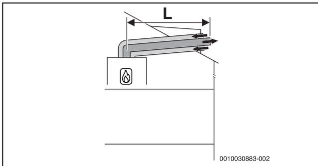
Bild 27 Horizontale konzentrische Luft-Abgas-Führung nach C<sub>13x</sub> über das Dach
