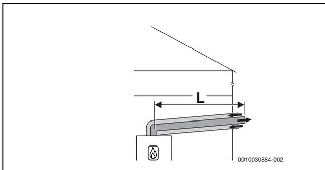
Bild 28 Horizontale konzentrische Luft-Abgas-Führung nach C<sub>13x</sub> durch die Außenwand
