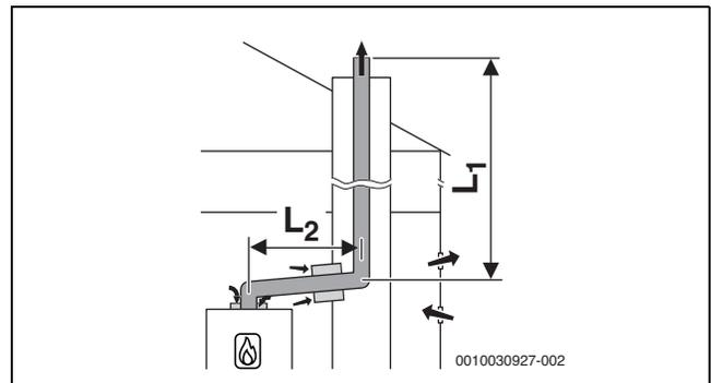
Bild 37 Starre Abgasführung im Schacht nach B<sub>23p</sub>/B<sub>53p</sub> mit raumluftabhängiger Luftzufuhr am Gerät und konzentrischem Verbindungsstück zwischen Aufstellraum und Schacht
