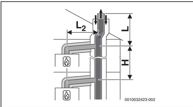
Bild 46 Mehrfachbelegung nach C<sub>(14)3x</sub> mit kollektiver flexibler Abgasableitung und konzentrischer Luft-Abgas-Führung im Aufstellraum
