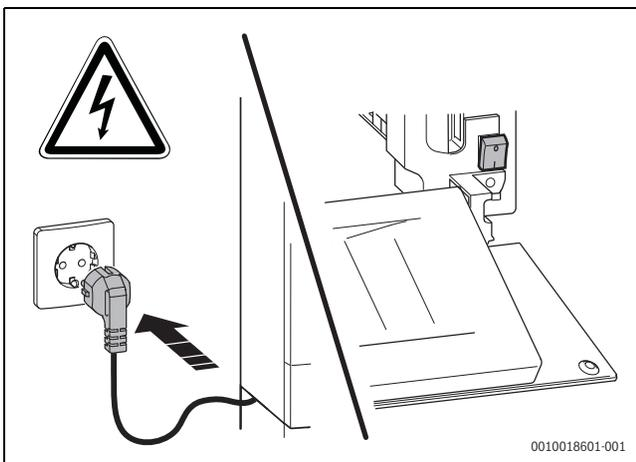
Bild 55 Netzspannung einschalten
