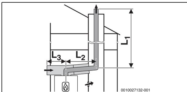
Bild 32 Starre Abgasführung nach C<sub>53x</sub> im Schacht und Luft-Abgas-Führung mit separater Luftzufuhr und konzentrischer Abgasleitung im Aufstellraum
