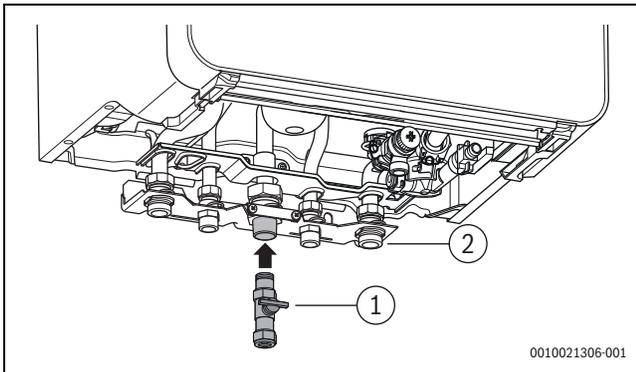
Bild 14 Gasanschluss herstellen
