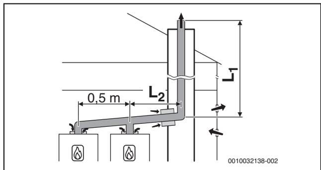
Bild 47 Kaskade mit 2 Geräten: Starre Abgasführung im Schacht nach B<sub>23p</sub>/B<sub>53p</sub> mit raumluftabhängiger Luftzufuhr am Gerät
