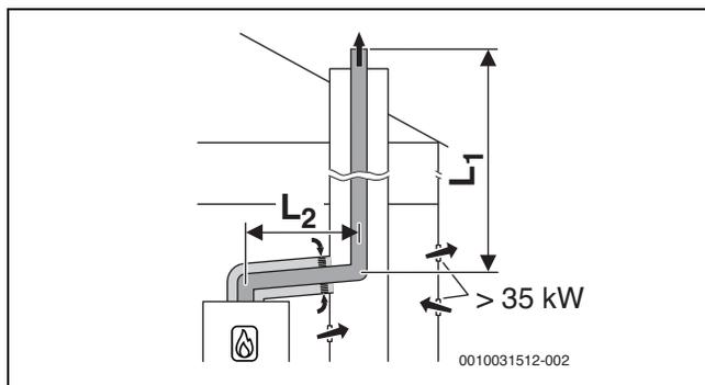
Bild 39 Starre Abgasführung im Schacht nach B<sub>33</sub> mit raumluftabhängiger Luftzufuhr über die konzentrische Luft-Abgas-Führung im Aufstellraum
