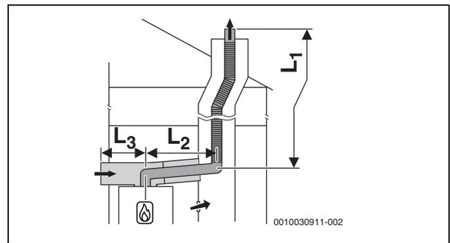
Bild 33 Flexible Abgasführung nach C<sub>53x</sub> im Schacht und Luft-Abgas-Führung mit separater Luftzufuhr und konzentrischer Abgasleitung im Aufstellraum
