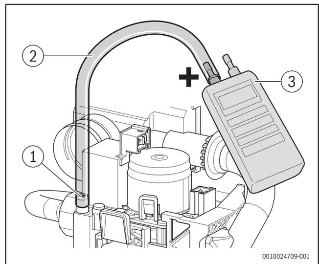
Bild 56 Gas-Anschlussdruck messen
