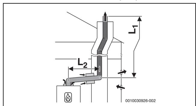
Bild 38 Flexible Abgasführung im Schacht nach B<sub>23p</sub>/B<sub>53p</sub> mit raumluftabhängiger Luftzufuhr am Gerät und konzentrischem Verbindungsstück zwischen Aufstellraum und Schacht
