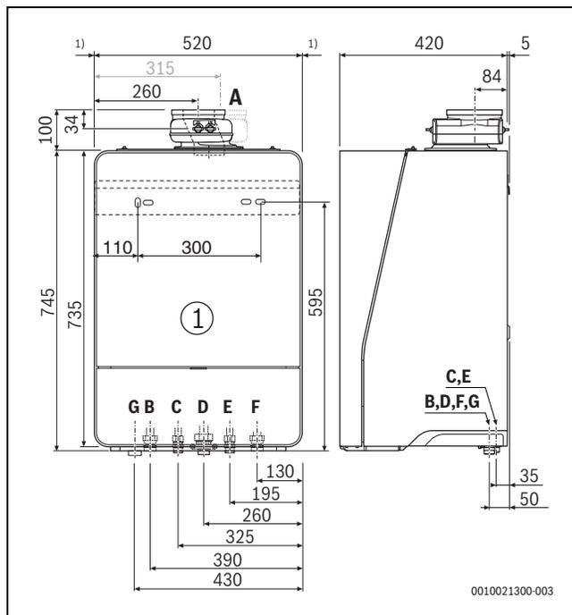
Bild 4 Typ E - Abmessungen und Anschlüsse [mm]
