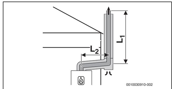
Bild 34 Konzentrische Luft-Abgas-Führung nach C<sub>53x</sub> an der Außenwand
