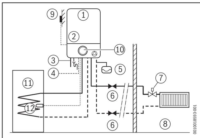
Bild 18 Anwendungsbeispiel mit außentemperaturgeführter Regelung und Warmwasserspeicher
