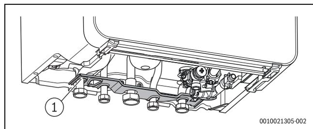
Bild 13 Entfernen Transporthalterung
