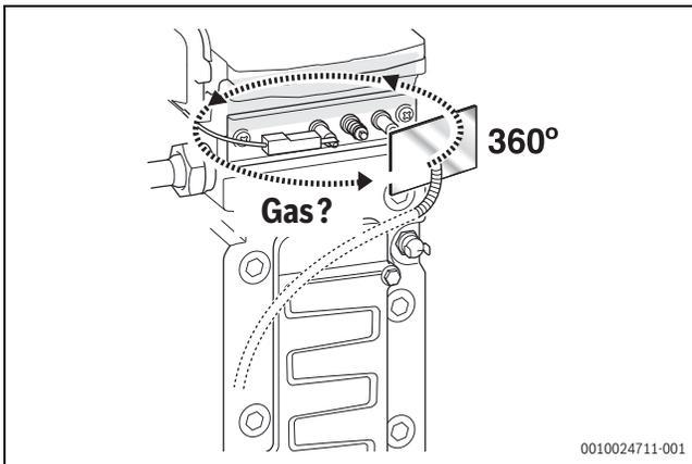
Bild 68 Dichtheitsprüfung
