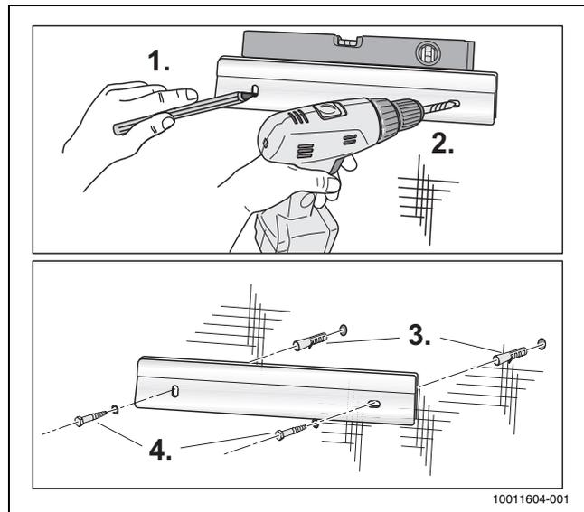
Bild 12 Aufhängeschiene montieren
