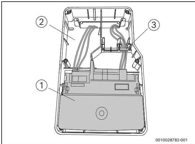
Bild 53 Funktionsmodul in Modulbox einbauen
