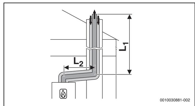
Bild 29 Konzentrische Luft-Abgas-Führung nach C<sub>33x</sub> im Schacht
