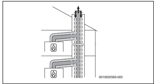
Bild 41 Mehrfachbelegung nach C<sub>(10)3x</sub> mit konzentrischer Luft-Abgas-Führung im Aufstellraum
