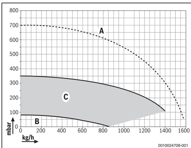
Bild 7 Restförderhöhe bei Einstellung 0
