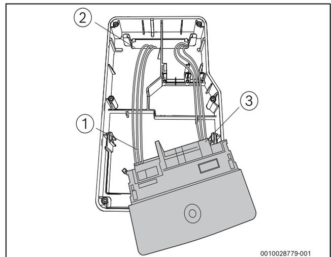
Bild 52 Funktionsmodul anschließen
