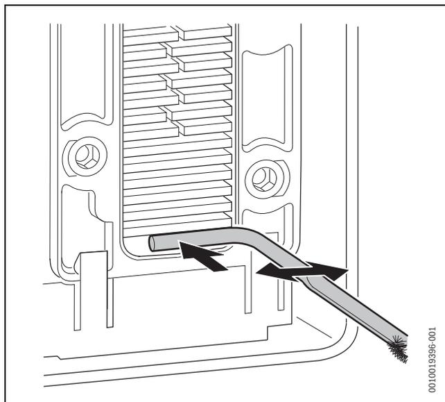
Bild 77 Kondensatwanne reinigen
