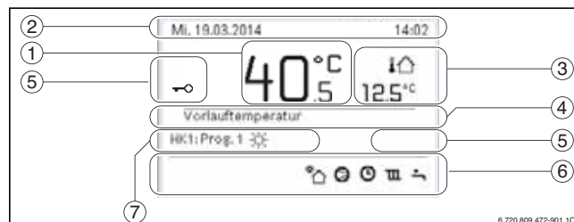
Bild 55 Beispiel für die Standardanzeige HPC 400 bei einer Anlage mit mehreren Heiz-/Kühlkreisen
