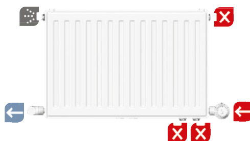
C: Anschluss reitend Achtung: Minderleistung
