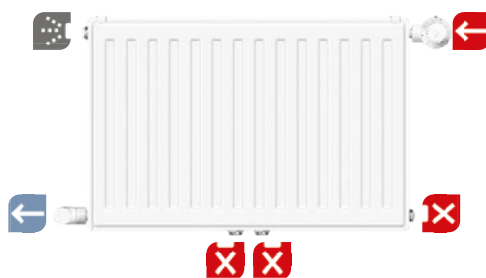
B: Anschluss wechselseitig
