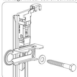
Montage mit der unteren Schraube
