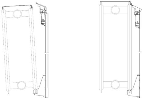
Adapter gegen Seitenverschiebung auf die obere oder untere Schraube setzen und zwischen die vertikalen Wasserkanäle fixieren. Schraube wieder festschrauben.
