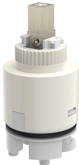
HANSAECO Steuerpatrone 3.5; Wasserbremse bei ca. 50% Wassermenge; mit Keramikscheiben; einstellbare Heißwassersperre; einstellbare Wassermengenbegrenzung bis ca. 6 l/min
