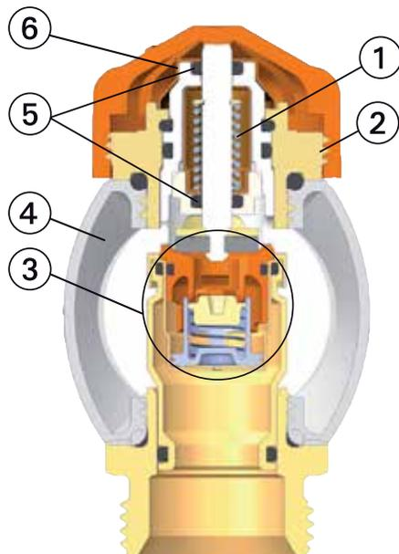
1. Die starke Druckfeder in Kombination mit hoher Stellkraft stellt sicher, dass das Ventil nach längerem Schließen nicht festsetzt
