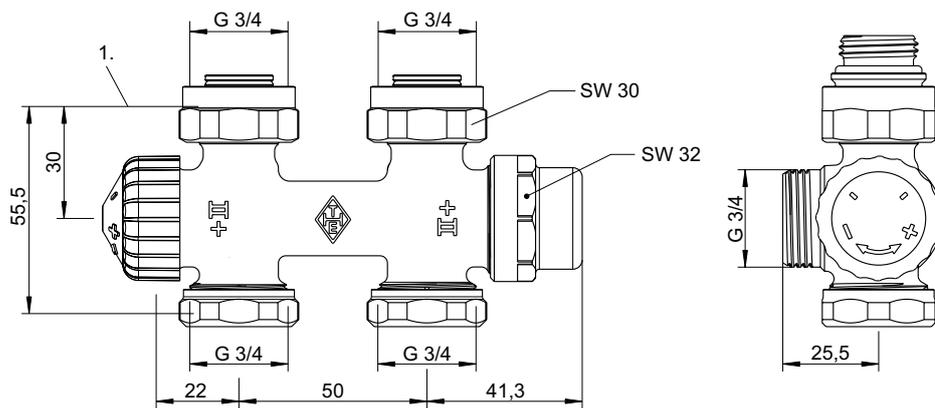
1. Auflagefläche Oberkante Dichtung
