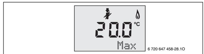
Bild 37 **Max** (= maximale Nennwärmeleistung) blinkt
