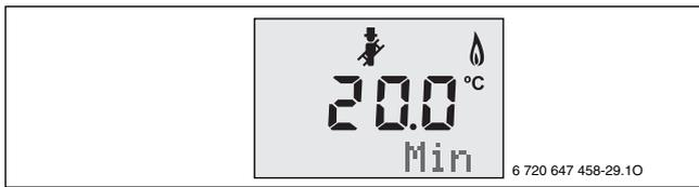
Bild 39 **Min** (= minimale Nennwärmeleistung) blinkt
