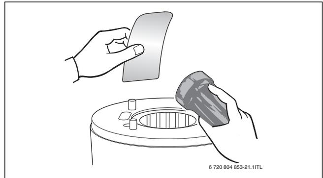
Bild 52 Wärmeblock auf Rückstände prüfen
