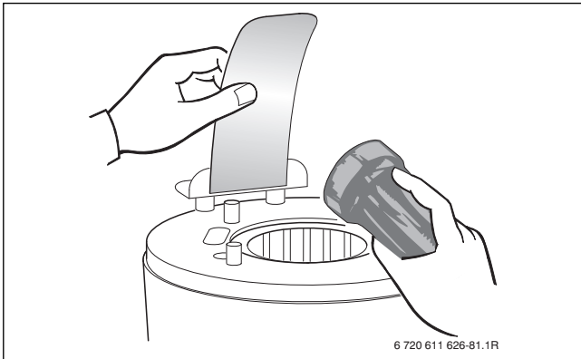
Bild 92 Wärmeblock auf Rückstände prüfen
