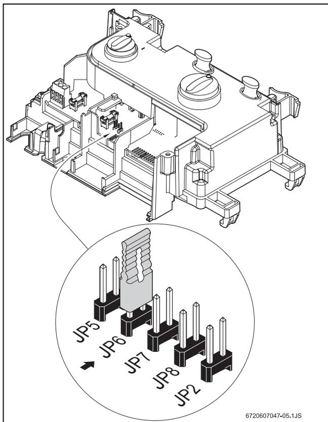
Fig. 10 Posizione morsetti e ponticello
