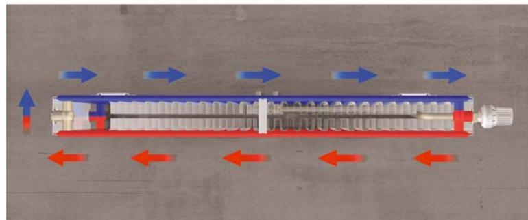
Planungsfreiheit: Bei der Ausführung mit Mittenanschluss lassen sich Heizkörpertyp und -dimension auch nach der Rohrinstallation noch frei bestimmen.
