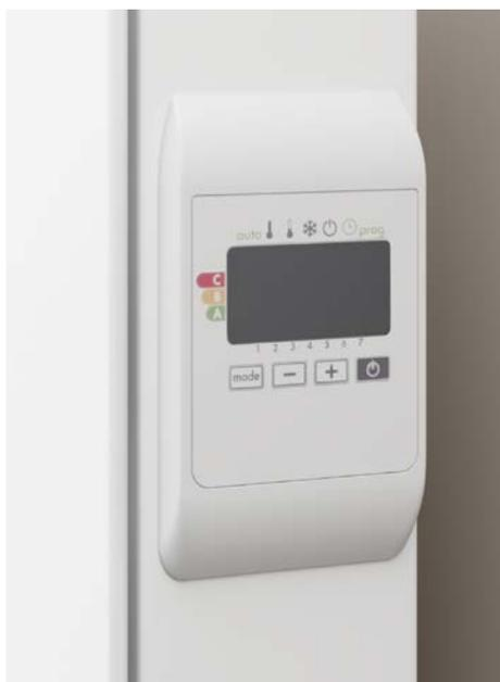
Der einfach zu bedienende, programmierbare Regler mit integrierter Frostschutzfunktion und LCD-Display ist ab Werk rechts oder links am Heizkörper montiert und lässt eine Raumtemperaturregelung von 7 °C bis 30 °C zu.
