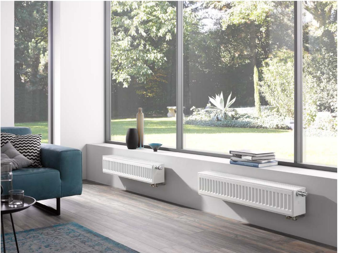
Planungsfreiheit: Bei der Ausführung mit Mittenanschluss lassen sich Heizkörpertyp und -dimension auch nach der Rohrinstallation noch frei bestimmen.
