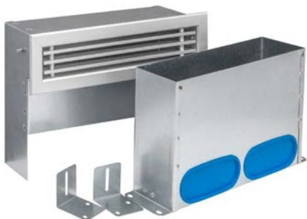
Wandauslass für Flachrohr 132 × 52 mm inklusive Auslassgitter aus Metall. Der Luftauslass ist bis max 50m<sup>3</sup>/h einsetzbar (2 Anschlussrohre nötig) Für Lüftungsrohr flach. Anschluss Verteiler/Sammler wird zusätzlich benötigt. Mit Bauschutzabdeckung.
