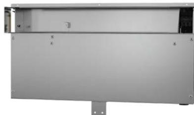
Beheizbarer Luftdurchlass für den Einsatz im Zuluftbereich. Geeignet für eine Montage in der Decke und in der Wand. Eigene Heizleistungsregelung in Abhängigkeit der Luftmenge durch PTC-Heizelement. Für Lüftungsrohr flach. Mit Übergangsstück auch für Rundrohr einsetzbar. Ausführung SEA500 ohne elektrischem Heizelement für die Abluft mit optionalem Filter einsetzbar.
