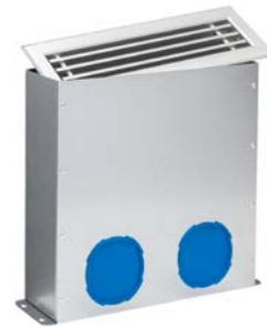
Der Boden-Luftauslass mit Metallgitter wird im Zuluftbereich eingesetzt. Das Ausblasgitter ist bis max. 50 m<sup>3</sup>/h (2 Anschlussrohre nötig) einsetzbar. Für das Lüftungsrohr rund wird zusätzlich ein Anschluss Verteiler/Sammler benötigt. Die mitgelieferte Bauschutzabdeckung dient zum Schutz vor Staub während der Bauphase.
