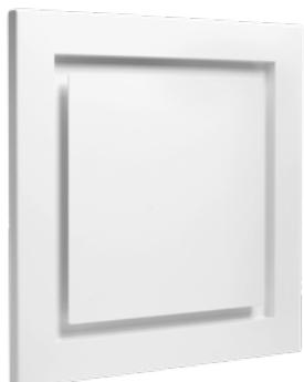
Für den Anbau an Decken und Wände über 125 mm Anschlussstutzen. Hundert Prozent freier Querschnitt. Kombinierbar mit Volumen- oder Filtereinsatz. Die bündige Federblech-Abdeckung sorgt für ein konstant schlankes Design mit einem symmetrischen, strömungsoptimierten Luftdurchlass. Ventil aus Stahlblech mit elektrostatischer Pulverbeschichtung.
