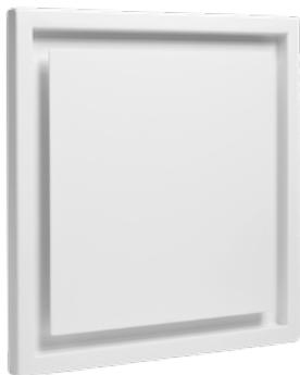
Für den Anbau an Decken und Wände über 125 mm Anschlussstutzen. Hundert Prozent freier Querschnitt. Kombinierbar mit Volumen- oder Filtereinsatz. Die bündige Federblech-Abdeckung sorgt für ein konstant schlankes Design mit einem symmetrischen, strömungsoptimierten Luftdurchlass. Ventil aus Stahlblech mit elektrostatischer Pulverbeschichtung.
