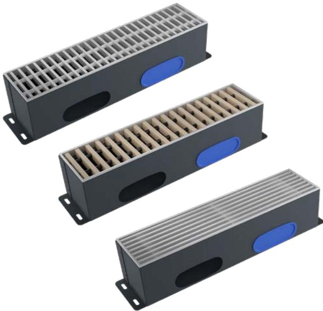
Boden-Luftauslass Für Flachrohr 132×52 mm inklusive Auslassgitter. Boden-Luftauslässe sind ausschließlich im Zuluftbereich einsetzbar. Es wird zusätzlich der Adapter Y 22 01 075 003 K benötigt. Mit Bauschutzabdeckung.
