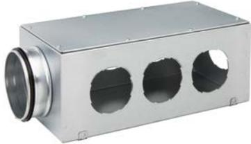
Verteiler/Sammler aus feuerverzinktem Stahl mit 7 Anschlussmöglichkeiten für Lüftungsrohr rund. Einsetzbar bis 150 m<sup>3</sup>/h, Anschlussstutzen NW 125 mm (Muffe).
