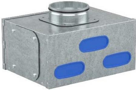
Verteiler/Sammler aus feuerverzinktem Stahl mit 8 Anschlussmöglichkeiten für Lüftungsrohr flach 132 mm×52 mm. Einsetzbar bis zu 150 m<sup>3</sup>/h (NW 125) und 300 m<sup>3</sup>/h (NW 160). Revisionsöffnung mit Anschlussstutzen NW 125 (Nippel) oder NW 160 (Nippel). Seitlicher Anschluss möglich.
