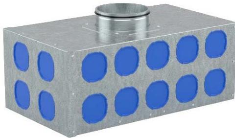
Verteiler/Sammler aus feuerverzinktem Stahl mit 8 Anschlussmöglichkeiten für den Flachkanal oder für das Rundrohr. Einsetzbar von 150 bis 400 m<sup>3</sup>/h. Anschlussstutzen 125 mm 160 mm oder 180 mm (Muffe)
