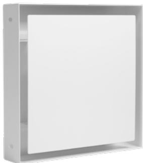
Für den Einbau in Trockenbaudecken und -wänden über 125 mm Anschlussstutzen. Hundert Prozent freier Querschnitt. Kombinierbar mit Volumen- oder Filtereinsatz. Die bündige Federblech-Abdeckung sorgt für ein konstant schlankes Design mit einem symmetrischen, strömungsoptimierten Luftdurchlass. Ventil aus Stahlblech mit elektrostatischer Pulverbeschichtung.
