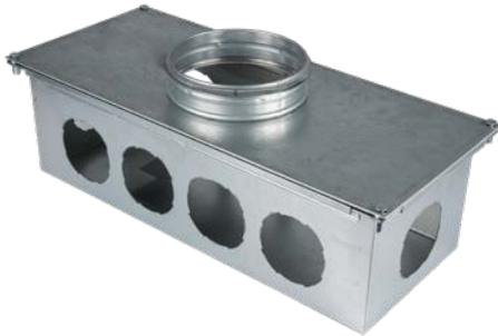
Verteiler/Sammler 10-fach. Für Zu- und Abluft wird je ein Luftverteiler benötigt, Ausführung identisch. 10 Anschlussmöglichkeiten für Lüftungsrohr rund. Einsetzbar bis 250 m<sup>3</sup>/h.
