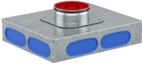
Verteiler/Sammler aus feuerverzinktem Stahl mit 8 Anschlussmöglichkeiten für Lüftungsrohr flach 132 mm×52 mm. Einsetzbar bis zu 150 m<sup>3</sup>/h. Revisionsöffnung mit Anschlussstutzen NW 125 (Nippel).
