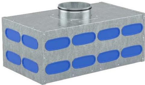
Verteiler/Sammler aus feuerverzinktem Stahl mit 8 Anschlussmöglichkeiten für Lüftungsrohr flach 132 mm×52 mm. Einsetzbar bis zu 200 m<sup>3</sup>/h (NW 125), 300 m<sup>3</sup>/h (NW 160) und 400 m<sup>3</sup>/h (NW 180). Revisionsöffnung mit Anschlussstutzen NW 125 (Nippel) oder NW 160 (Nippel). Seitlicher Anschluss möglich.
