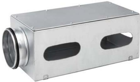
Verteiler/Sammler aus feuerverzinktem Stahl mit 5 Anschlussmöglichkeiten für Lüftungsrohr flach 132×52 mm. Einsetzbar bis 150 m<sup>3</sup>/h, Anschlussstutzen NW 125 mm (Nippel).
