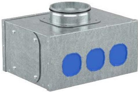
Verteiler/Sammler aus feuerverzinktem Stahl mit 8 Anschlussmöglichkeiten für den Flachkanal oder für das Rundrohr. Einsetzbar bis 150 m<sup>3</sup>/h oder 300 m<sup>3</sup>/h. Anschlussstutzen 125 mm oder 160 mm (Muffe)
