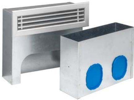
Der Wand-Luftauslass mit Metallgitter wird im Zu- oder Abluftbereich eingesetzt. Der Luftauslass ist nach oben oder unten bis max. 50 m<sup>3</sup>/h (2 Anschlussrohre nötig) einsetzbar. Für den Anschluss des Lüftungsrohrs rund wird zusätzlich ein Anschluss Verteiler/Sammler benötigt. Die mitgelieferte Bauschutzabdeckung dient zum Schutz vor Staub während der Bauphase.
