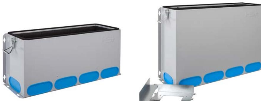
Für Zu- und Abluft wird je ein Luftverteiler benötigt, Ausführung identisch. Einsetzbar bis 350 m<sup>3</sup>/h. 14 Anschlussmöglichkeiten für Lüftungsrohr rund. In zwei Größen. Innenliegende Dämmung für die Schalldämpfung und Kondensatschutz. Inkl. Montageabdeckung für die Bauphase.
