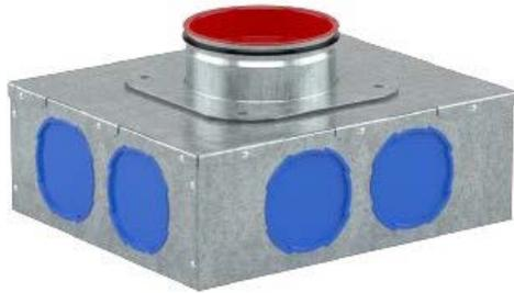
Verteiler/Sammler aus feuerverzinktem Stahl mit 8 Anschlussmöglichkeiten für den Flachkanal oder für das Rundrohr. Einsetzbar bis 150 m<sup>3</sup>/h. Anschlussstutzen 125 mm (Muffe).
