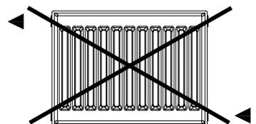
**Hinweis:** x2-Trennstopfen im Lieferumfang der mehrlagigen Flachheizkörper vorhanden. Montage bauseitig im Rücklauf (außer Bauhöhe 200 / 205 mm).
