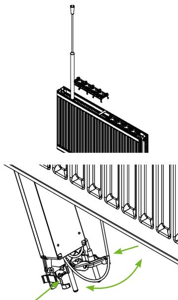
3. Lüfterbank von oben und unten mit einem Pinsel reinigen, anfallenden Staub mittels Staubsauger entfernen.
