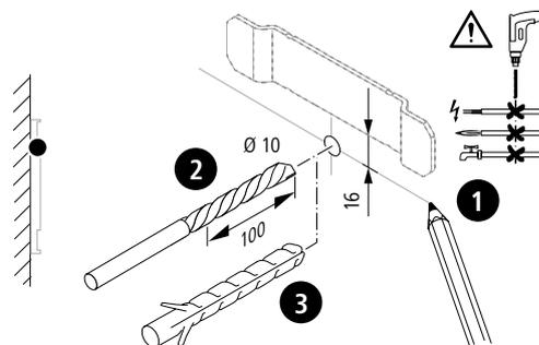
**Achtung!** Das Befestigungsmaterial ist für ausreichend tragfähige Untergründe bestimmt. Die jeweils geeignete Befestigungsmethode ist jedoch immer vor Ort zu prüfen und das Befestigungsmaterial auf die bauliche Situation abzustimmen! Zur Erhöhung der Tragfähigkeit kann eine dritte Schraube + Dübel eingesetzt werden.
