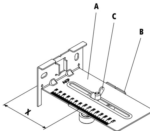
11. Anschlussverschraubungen an Spülbogen (B) anschließen. Die Heizungsrohre können nun nach dem Stand der Technik verlegt werden und mit handelsüblichen Anschlussverschraubungen am Spülbogen (B) angeschlossen werden.
