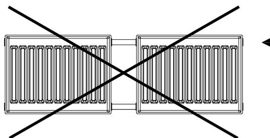
**Hinweis!** Trennstopfenart Art.-Nr. ZT00810001 erforderlich. Kopplung von Flachheizkörpern mit Bauhöhe 200/205 mm ohne Trennstopfen.
