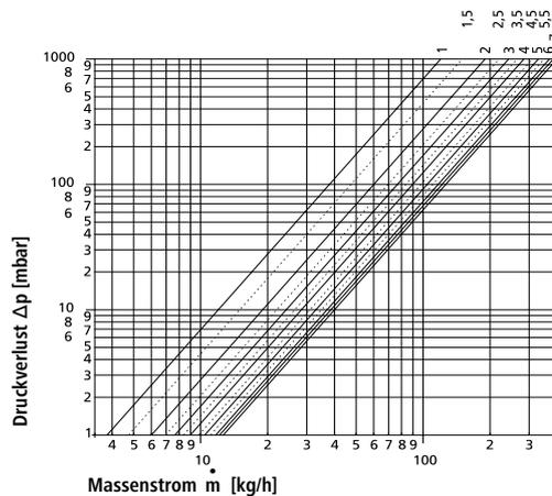
**Hinweis:** In diesem Diagramm ist der Druckverlust des Ventils berücksichtigt.
