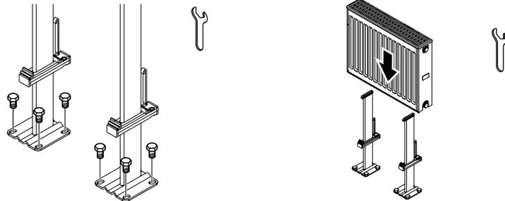
4. Verspannen der Konsole mit Heizkörper durch Festziehen der Mutter am Haken
