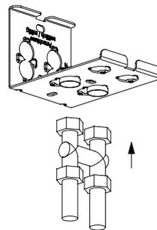
**Achtung!** Verbindung Anbindestopfen (B) und Anschlussverschraubungen ist nicht dicht. Eine Druckprüfung des Systems ist nur mit absperrbaren Verschraubungen möglich.
