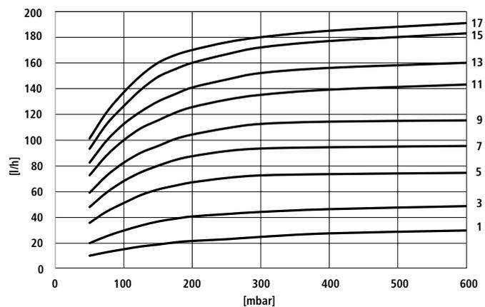
**Hinweis:** In diesem Diagramm ist der Druckverlust des Ventils berücksichtigt.
