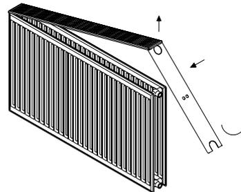
Danach die obere Abdeckung durch einseitiges Anheben und Verschieben von der zweiten seitlichen Abdeckung trennen.
