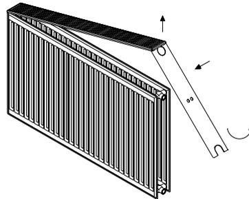
2. Reinigung des Heizkörpers von oben: je nach Länge jeweilige Lüfterbank nach oben ziehen, Heizkörper innen mit Reinigungsbürste reinigen.
