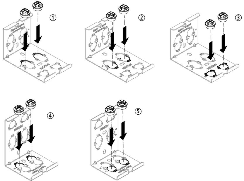
11. Anschlussverschraubung an Anbindestopfen (B) mit Hand ohne Werkzeug anschrauben.
