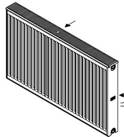
Eine seitliche Abdeckung leicht schräg vom HK abziehen (siehe Bild) und diese nach Anheben der oberen Abdeckung von den Befestigungshaken lösen.
