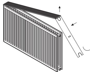
Danach die obere Abdeckung durch einseitiges Anheben und Verschieben von der zweiten seitlichen Abdeckung trennen.
