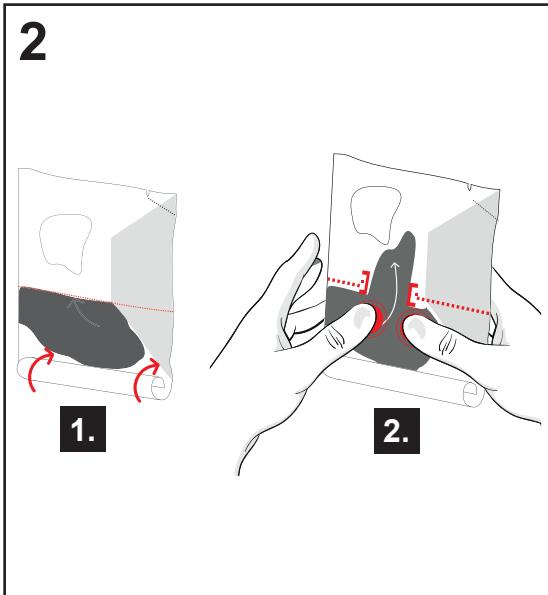
**DE** Klebstoffkammer umfalten und den Klebstoff in Richtung der schmalen Reaktionskammer drücken, bis die Trennnaht aufplatzt.
