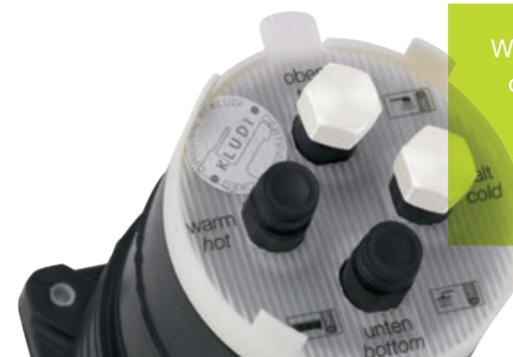
Auf den vier Spülrohren befinden sich Dichtungen, die, genau wie alle wasserführenden Bauteile, KTW/W270-zugelassen sind. Die Plattform, die später die Funktionseinheit aufnimmt, hat eine präzisionsbearbeitete Dichtfläche. Sie besteht aus entzinkungsbeständigem DZR-Messing und hat außenliegende DN 20-Anschlüsse, die von KLUDI auf Dichtheit geprüft sind.
