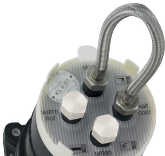
Sobald Sie für die Feininstallation den Deckel entfernen, ist das Spülset mit vier Rohren und der Platte aus glasfaserverstärktem Kunststoff sichtbar. Das hochwertige Material aus dem Automobilbau hat seine Stabilität in aufwendigen Tests bei Temperaturen von +90 °C bis -18 °C bewiesen. Während der Dichtheitsprüfung kann der Druck bis maximal 16 bar im Gesamtleitungssystem somit beibehalten werden.
