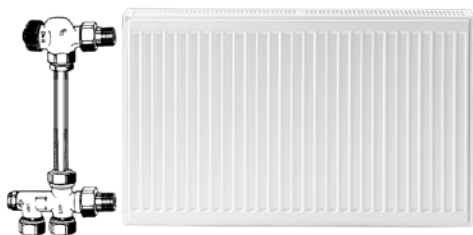
Abb. 68 Einrohranschluss mit hochgezogenem Vorlauf (bauseits)
