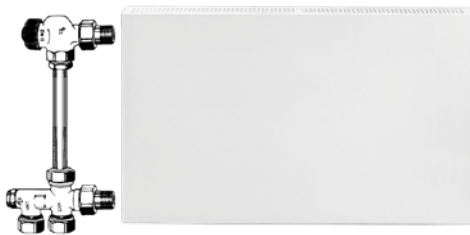
Abb. 58 Einrohranschluss mit hochgezogenem Vorlauf (bauseits)
