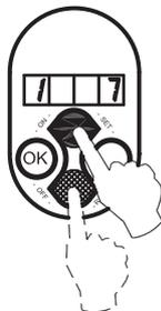
4. Mit Hilfe der Taste "OK" wird der Einstellwert des gewünschten Parameters angezeigt.
