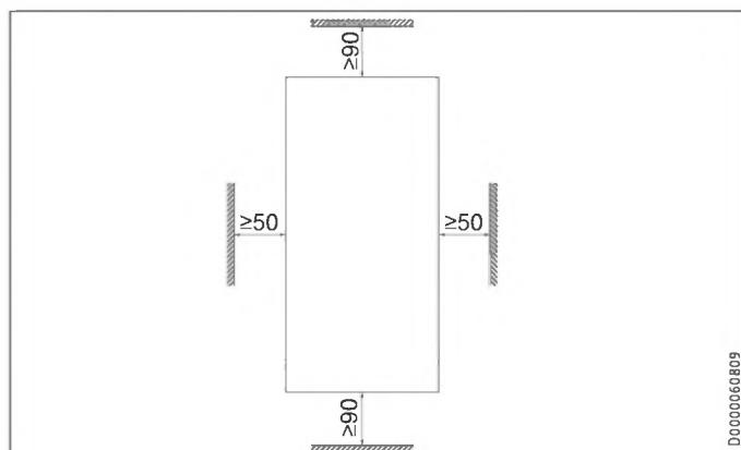
► Dodržujte minimální vzdálenosti tak, abyste zajistili bezproblémový provoz přístroje a umožnili snadné provádění jeho údržby.
