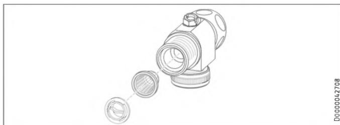
La vanne d'arrêt à boisseau sphérique à 3 voies contient un filtre. En cas d'encrassement, ce filtre peut être démonté et nettoyé.
