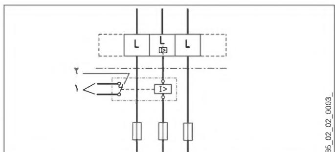
١ وصلة التحكم لحماية التشغيل للجهاز الثاني (مثلاً سخانات كهربائية بخزان).
