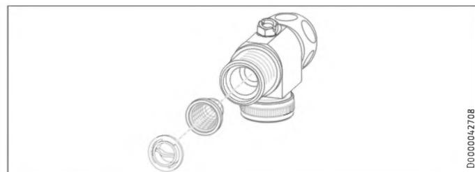
Hay un filtro en la válvula de cierre de bola de 3 vías. Si está sucio, puede desmontar el filtro y limpiarlo.
