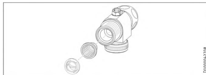
Im 3-Wege-Kugelabsperrventil befindet sich ein Sieb. Bei Verschmutzung können Sie dieses Sieb ausbauen und reinigen.
