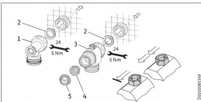
1 Circuito de agua caliente con pieza en T
