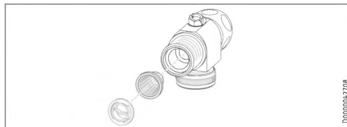
V třícestném kulovém uzavíracím ventilu se nachází sítník. Při znečištění můžete sítník vyjmout a vyčistit.
