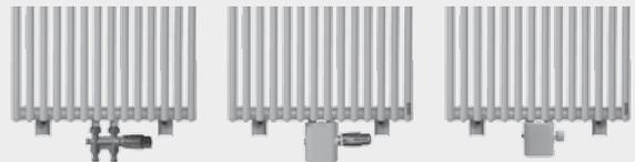
Sowohl beim neuen Monoblockmittelanschluss 1mm8 (1188) als auch beim Mittelanschluss 1mm8 (1008) anwendbar. Der Anschluss an der Ventilgarnitur hat 2 x 3/4" Außengewinde. Bei der Anwendung der Vasco-mm-Ventilgarnitur ist ein Austausch von Vorlauf und Rücklauf möglich. Das eventuelle Strömungsrohr muss immer auf der Seite des Vorlaufs montiert werden.
