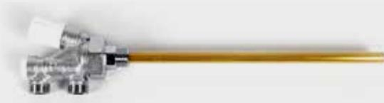
Über den Bypass kann Vorlaufwasser direkt in den Rücklauf gemischt werden. Bei Verwendung in einem Zweirohrsystem muss der Bypass geschlossen werden. Das Ventil wird vor allem bei Heizkörpern mit einem waagerechten Verteiler angewandt.
