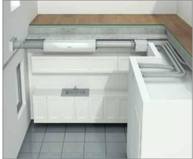
Abb 38: Einbaubeispiel Kombierter Luftverteiler/ -sammler
