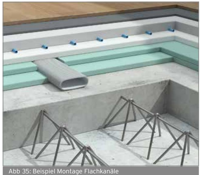
Abb 35: Beispiel Montage Flachkanäle
