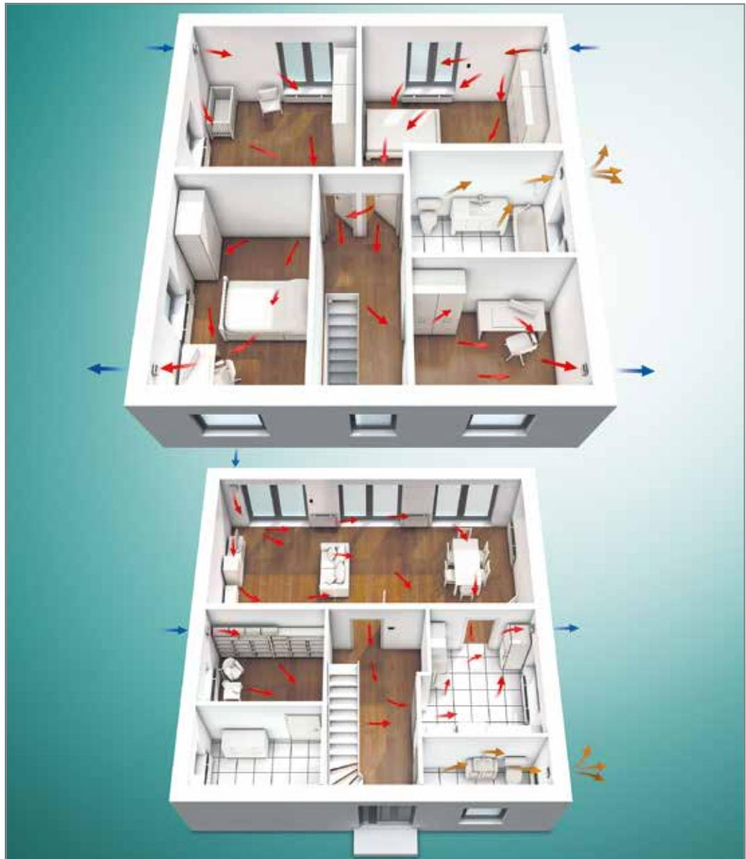
Abb 112: Dezentrale Lüftung mit Wärmerrückgewinnung in Ein- und Zweifamilienhäusern
