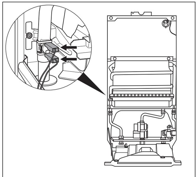
**Abb. 7.5 Steckkontakte Sicherheitstempurbegrenzer**
