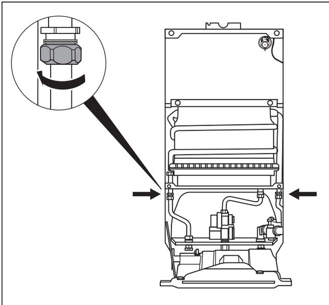
**Abb. 7.6 Verschraubungen Wasseranschlüsse Geräteheizkörper (abgebildet Typ 16-2/0)**
