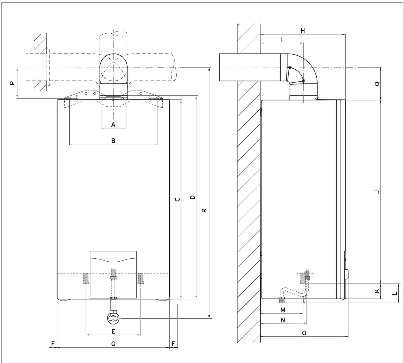
Abb. 4.2 Maßzeichnung turboMAG 16-2/0
