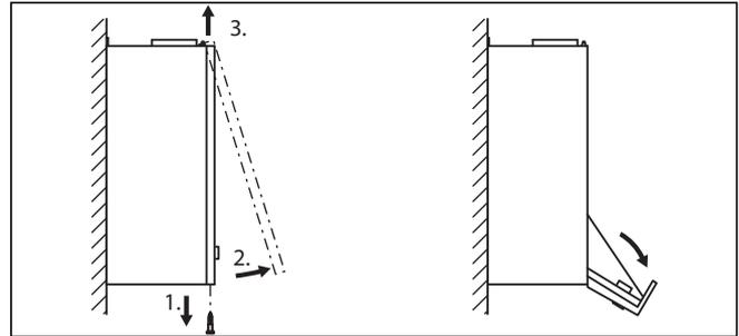
Abb. 4.4 Demontieren der Gehäusefront
