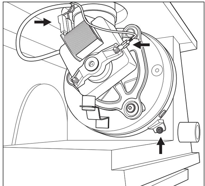
Abb. 7.2 Ventilatorausbau Typ 16-2/0
