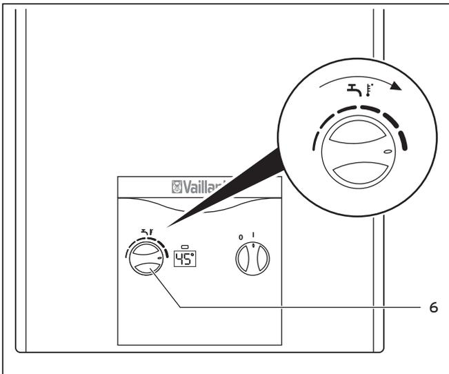
Abb. 6.6 Einstellen der Maximaltemperatur
