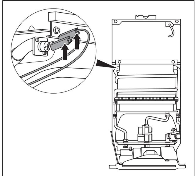
**Abb. 7.4 Steckkontakte Sicherheitstempurbegrenzer**
