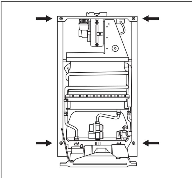
Abb. 4.6 Demontage Seitenteile.
