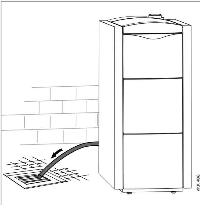
Abb. 4.6 Kondenswasserablauf montieren
