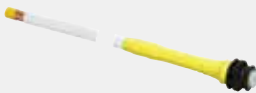
Geopress K-Übergangsstück mit SC-Contur - für PE-Rohr auf Kupferrohr, Erdgasanlage, Flüssiggasanlage - Kunststoff - Übergang Siliziumbronze und Kupfer - Pressanschluss Modell 9713.1
