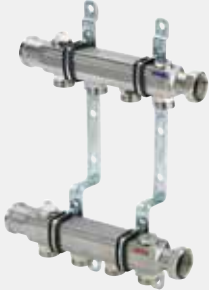
Verteiler - für Heizungs-Installation - Edelstahl - Eurokonus, Überwurfmutter G1 flachdichtend Ausstattung Anschluss links- und rechtsseitig, Halterungen Stahl verzinkt, Entlüftungsventil, Vorbereitung für Messstülle mit R1/2-Stopfen Modell 1078
