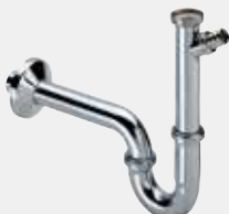
Röhrengeruchverschluss Plus-Siphon - Messing verchromt Ausstattung Schlauchverschraubung G¾, Verschlussplatte, Verstellrohr 200 mm, Ablaufbogen 220 mm güteüberwacht nach DIN EN 274 Modell 5611.6
