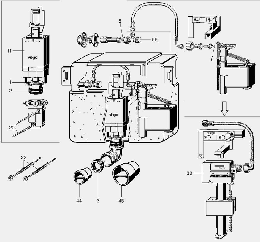
UP-Spülkasten 2L für Visign-Betätigungsplatten, Ausführung niedrige Bauhöhe,
