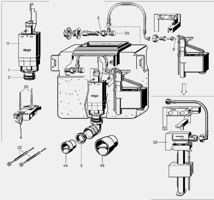
UP-Spülkasten 2L für Visign-Betätigungsplatten, Ausführung niedrige Bauhöhe, Betätigung von vorn oder oben, ab Baureihe 2014, eingesetzt im: Steptec-Modell 8430.3 und 8430.18
